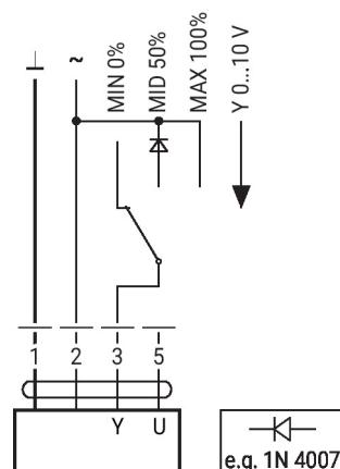
Commande à distance 0...100% avec positionneur SG.
