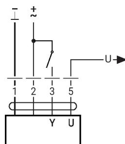
Commande forcée et limitation avec alimentation AC 24 V par un commutateur rotatif
