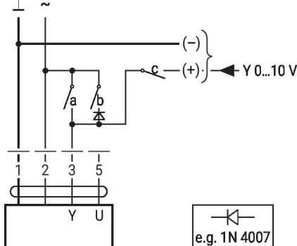
Commande forcée avec commutateur rotatif AC 24 V
