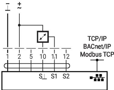
Raccordement de contact de commutation
