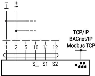
TCP/IP (nuage) / BACnet/IP / Modbus TCP avec point de consigne analogique (fonctionnement hybride)
