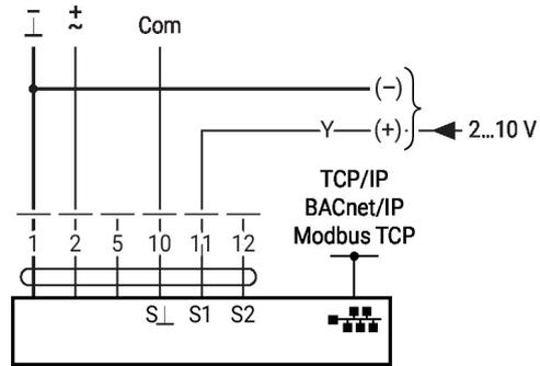
Raccordement du capteur
