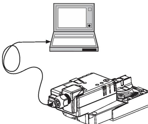
**Montage simple** Montage simple et direct sur l'axe de registre avec une noix d'entraînement universelle, fournie avec un mécanisme anti-rotation pour empêcher au servomoteur de tourner.
