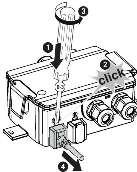
**Collega attuatore** Per assicurare la protezione IP e il collegamento elettrico, la spina del connettore VST deve essere completamente inserita nella presa del connettore. A tale scopo è necessaria una certa forza.
