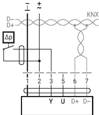
Requisiti per il contatto in commutazione: il contatto di commutazione deve essere in grado di scambiare accuratamente una corrente di 16 mA @ 24 V.
