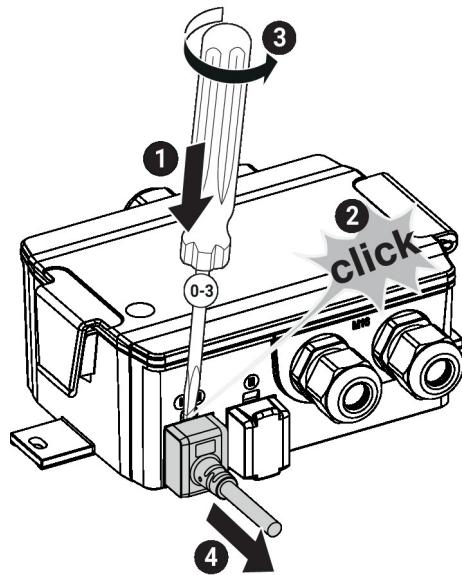
**Collega attuatore** Per assicurare la protezione IP e il collegamento elettrico, la spina del connettore VST deve essere completamente inserita nella presa del connettore. A tale scopo è necessaria una certa forza.
