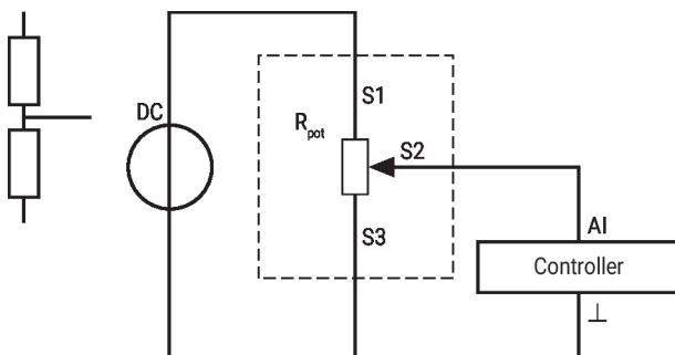
Se il potenziometro viene utilizzato principalmente nello stesso range di angolo ridotto, si consiglia di cablarlo come divisore di tensione.
