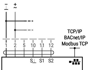
TCP/IP (Cloud) / BACnet/IP / Modbus TCP con setpoint analogico (funzionamento ibrido)
