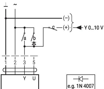
Controle manual com AC 24 V com switch rotativo
