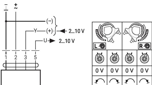
Diagrama de fiação da operação "sobreposto" (atuadores acoplados mecanicamente)
