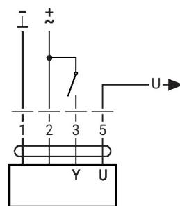
Controle manual e limitação com AC 24 V com switch rotativo
