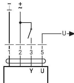
Controle manual e limitação com AC 24 V com switch rotativo
