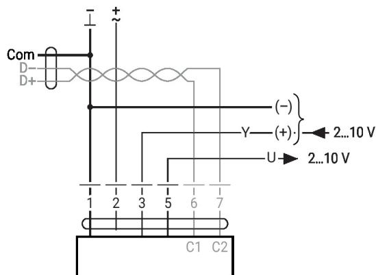
BACnet MS/TP / Modbus RTU
