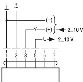
Modbus RTU/BACnet MS/TP com valor de referência analógico (operação híbrida)
