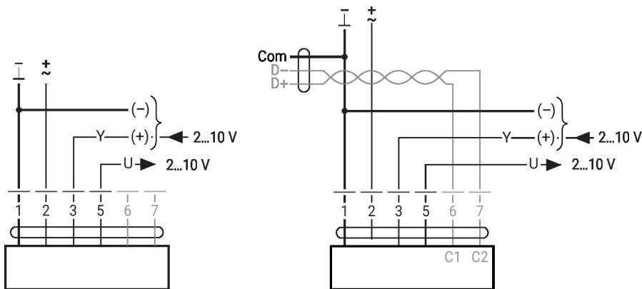
BACnet MS/TP / Modbus RTU
