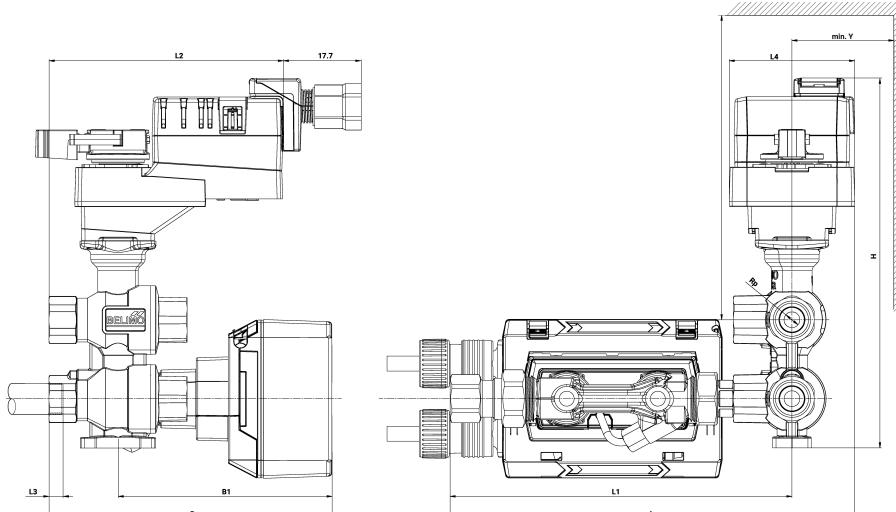
O sensor de vazão e o elemento da tubulação também podem ser conectados à porta 3 (consulte as notas de instalação).
