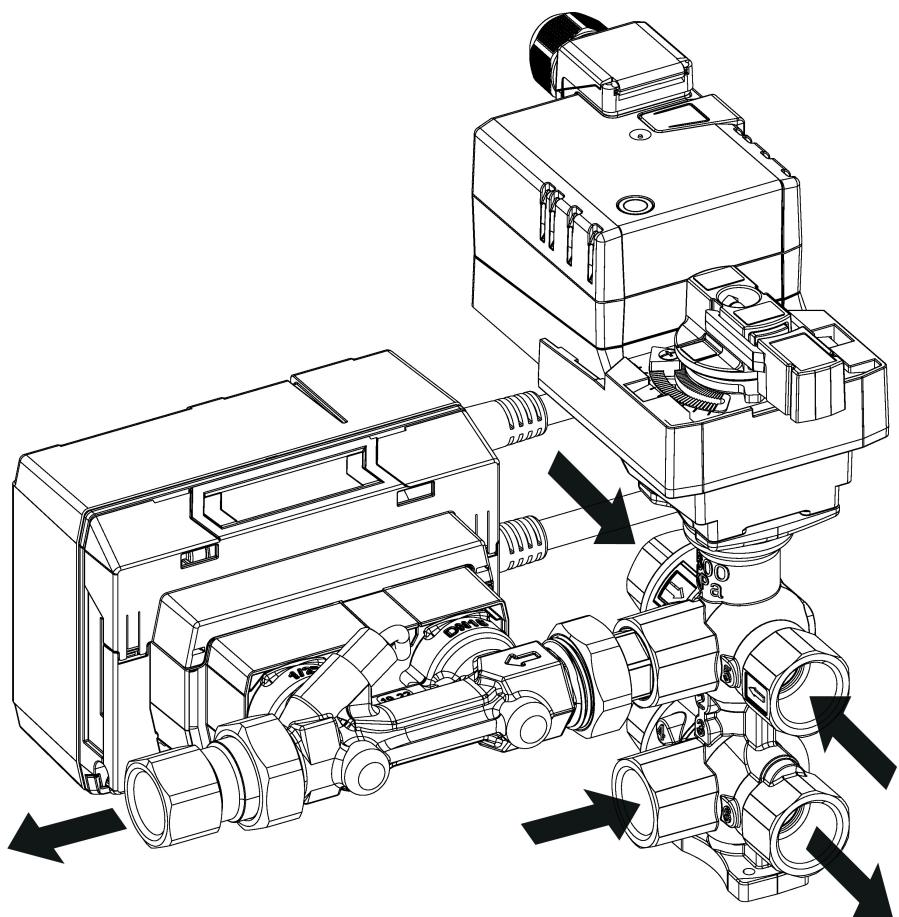
Sensor de vazão no retorno
