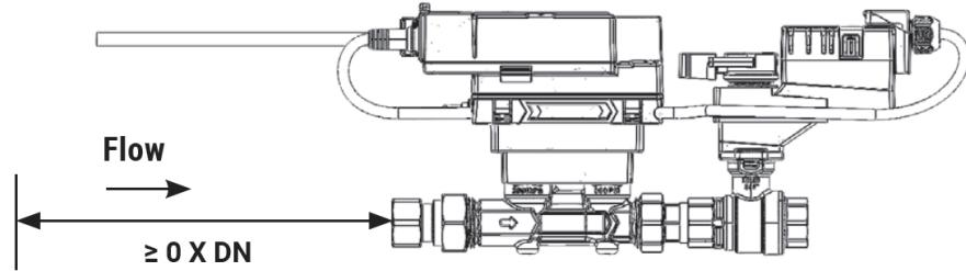
**Instalação separada** A combinação válvula-atuador pode ser montada separadamente do sensor de fluxo. O sentido do fluxo de ambos os componentes deve ser observado.
