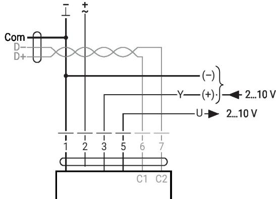
BACnet MS/TP / Modbus RTU
