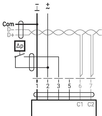
Requisitos do contato switch: o contato switch deve conseguir alternar a corrente de 16 mA a 24 V com precisão.
