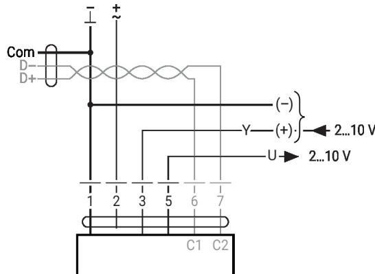
BACnet MS/TP / Modbus RTU
