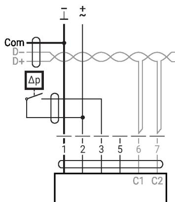
Requisitos do contato switch: o contato switch deve conseguir alternar a corrente de 16 mA a 24 V com precisão.
