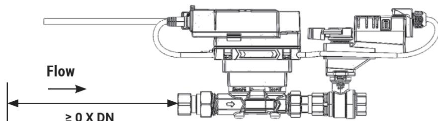
**Instalação separada** A combinação válvula-atuador pode ser montada separadamente do sensor de fluxo. O sentido do fluxo de ambos os componentes deve ser observado.
