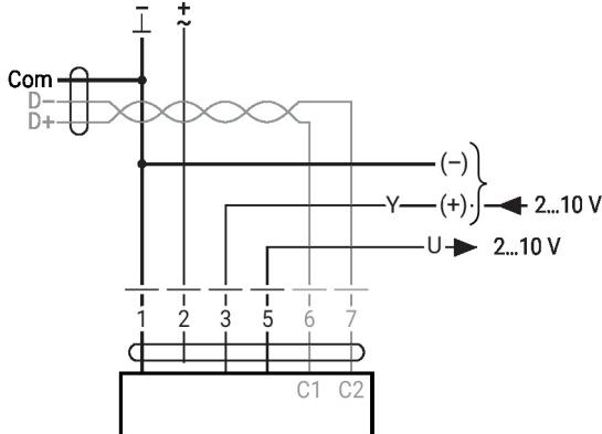
BACnet MS/TP / Modbus RTU
