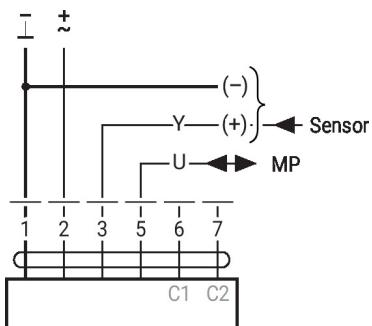
**Instalação elétrica****Conversor para sensores**
