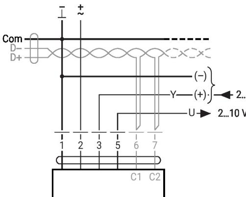
MP-Bus, alimentação via conexão de fio triplo
