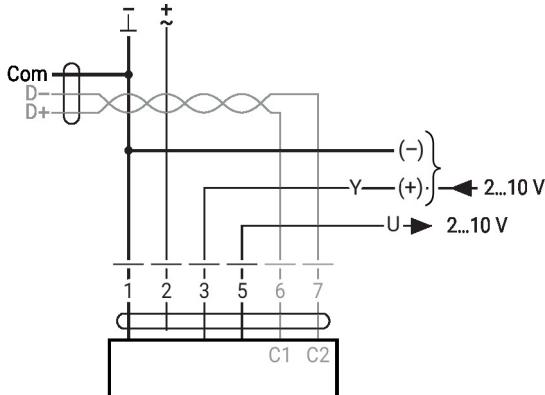
BACnet MS/TP / Modbus RTU
