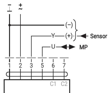
**Instalação elétrica****Conversor para sensores**
