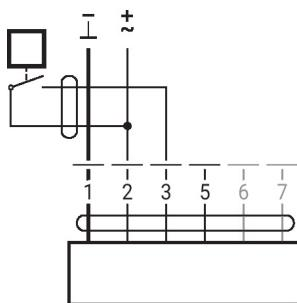
Conexão com sensor ativo
