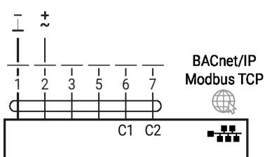
MP-Bus, alimentação via conexão de fio triplo
