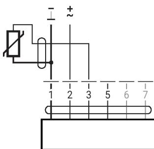
Conexão com contato switch
