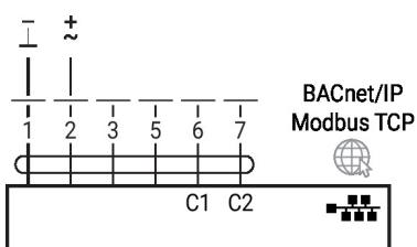
MP-Bus, alimentação via conexão de fio triplô
