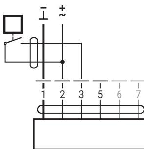
Conexão com sensor ativo
