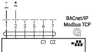
MP-Bus, alimentação via conexão de fio triplo
