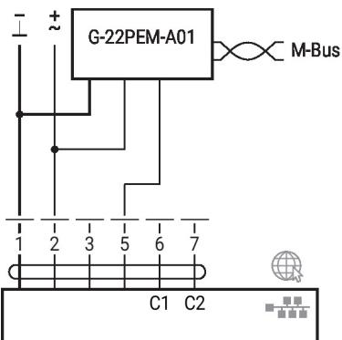
M-Bus com conversor em modo paralelo com PoE com BACnet/IP / Modbus TCP
