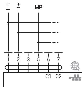
PoE com BACnet/IP / Modbus TCP
