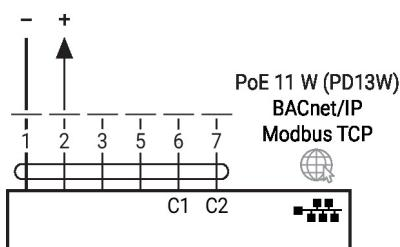
MP-Bus, alimentação via conexão de fio triplo
