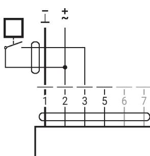
Conexão com sensor ativo
