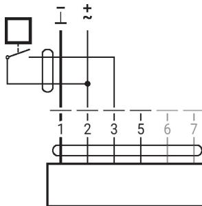
Conexão com sensor ativo
