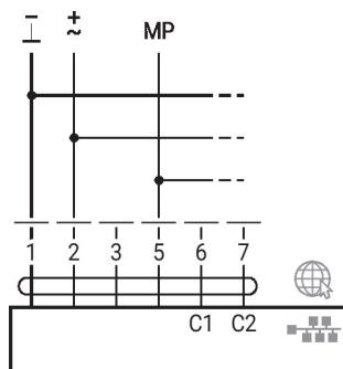
PoE com BACnet/IP / Modbus TCP
