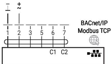
MP-Bus, alimentação via conexão de fio triplo
