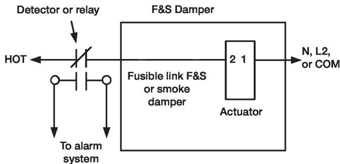
Fiação típica ou amortecedor de link fusível
