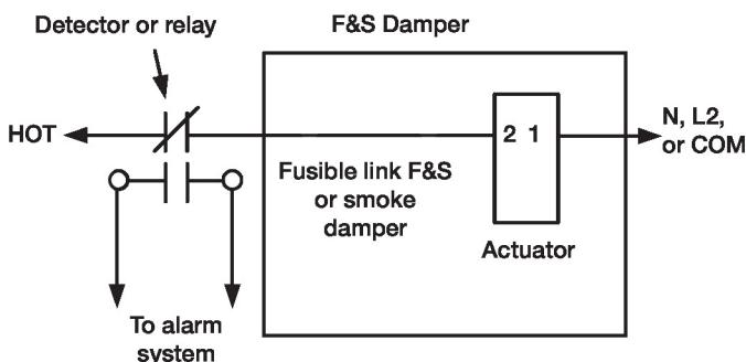
Fiação típica ou amortecedor de link fusível
