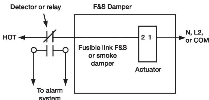
Fiação típica ou amortecedor de link fusível
