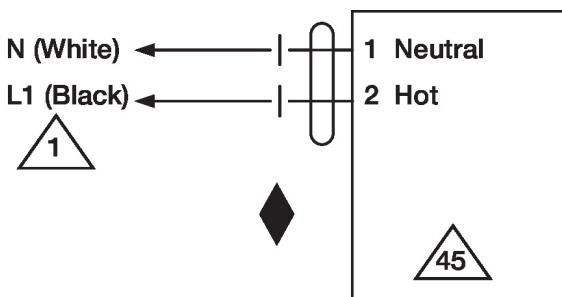
Fiação típica ou amortecedor de link fusível
