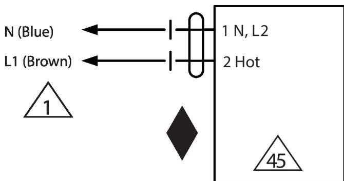
Fiação típica ou amortecedor de link fusível
