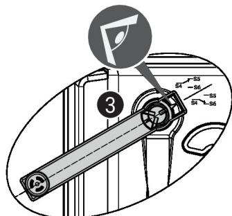
Nas definições da posição do switch de controle, execute os pontos 1 a 4 sucessivamente.
