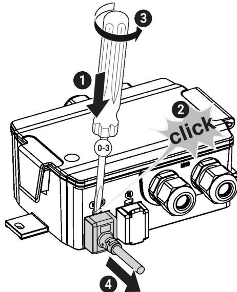
**Conecte o atuador** Para garantir a proteção IP e a conexão elétrica, o plugue do conector VST deve ser totalmente inserido no conector macho. Para isso, é necessária uma certa quantidade de força.
