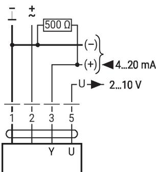
O resistor de 500 Ohm converte
