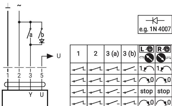
Controle manual e limitação com AC 24 V com switch rotativo
