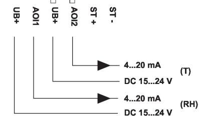
只有当湿度输出AOU1和两个UB+输入连接时才能获得正确的温度值。
