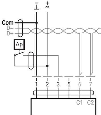
开关触点要求：开关触点必须能够在24 V下准确切换16 mA的电流。
