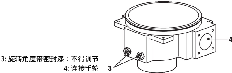
旋转角度机械限位、止付螺栓和辅助开关之间的关系
